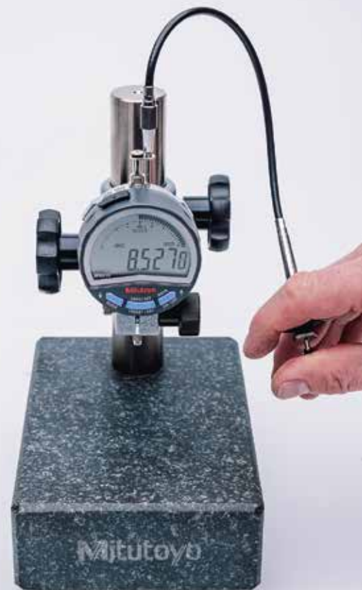
543-700B s volitelným příslušenstvím: stojanem 215-150-10 a drátovou spouští 21JZA295
